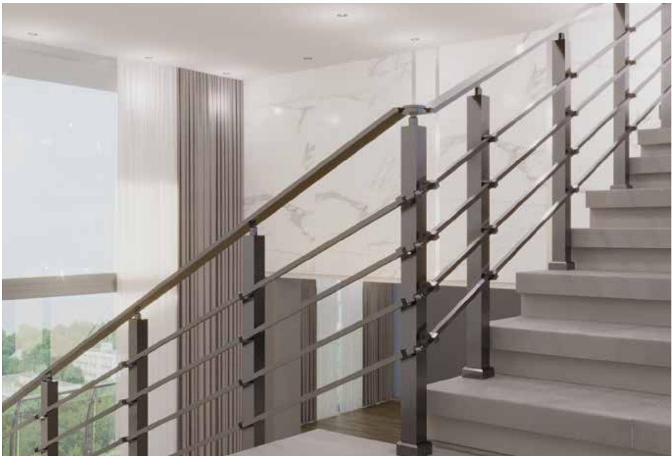
**Mafsallar:** Mafsal olarak adlandırdığımız aksesuar, iki parçadan oluşur. Dikme ile yatay üst küpeste profilini bir birine bağlamak için kullanılan aksesuardır. Mafsallar genelde merdiven ve eğimli yerlerde kullanılır.
